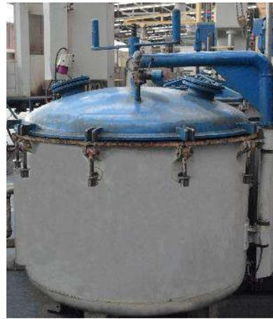
**Tanque de vacío para lacado.**
